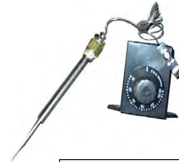
7. датчик выходящего газа
